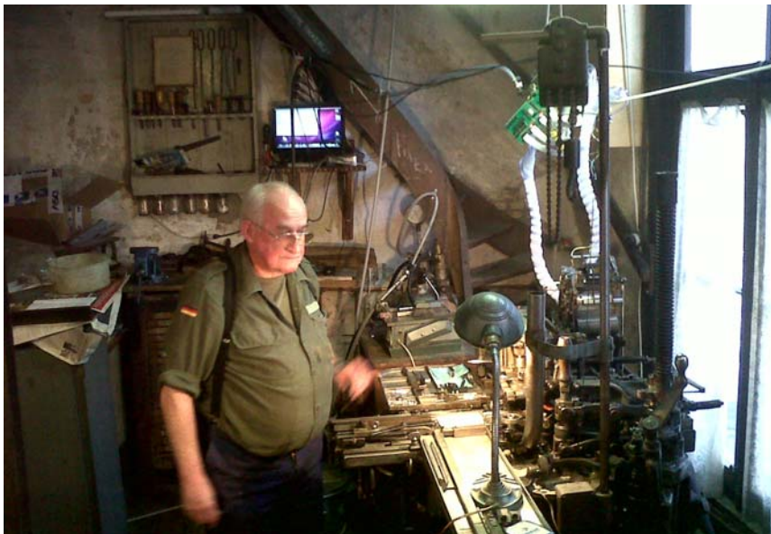
Gilbert aan de Monotype gietmachine. Achteraan de computer die via de aansturing van de luchtkleppen (hangend boven de gietmachine) verbonden is met de Monotype-gietmachine.
