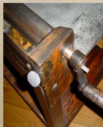
Detail van de inktbak met stelschroef waarbij de inktrol tegen het koperen inktmes wordt afgesteld.
