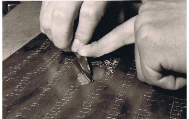
Met een schraapstaal werden de bramen weggeschraapt.
