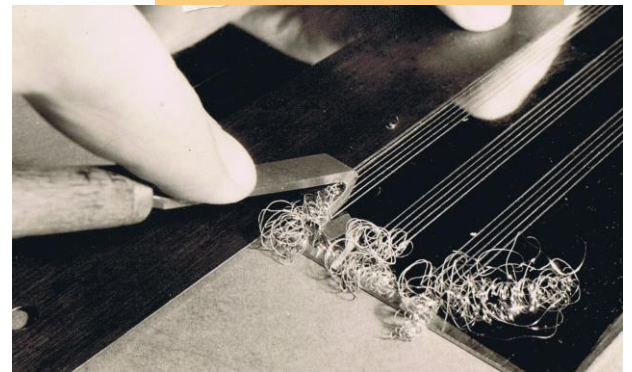
Met behulp van een vijftandige 'rastral' bekwam men met één trek een notenbalk in de loden plaat.
